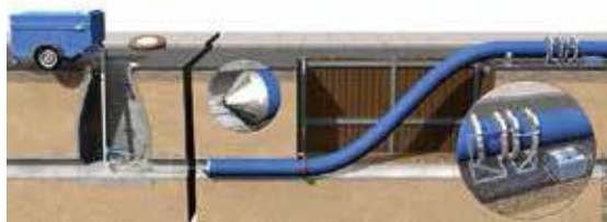
Slika 5.2.3. Relining dugačkih cijevi
