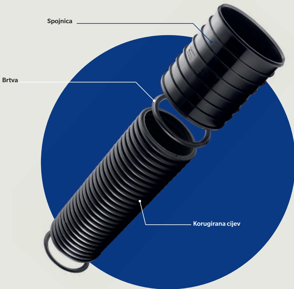
**Vargokor cijevni komplet** sastoji se od Vargokor korugirane cijevi, spojnice i dvije brtve. Princip spajanja sa spojnicom na jednom kraju cijevi i ravnim krajem s brtvom na drugom kraju cijevi omogućuje vrlo jednostavno i brzo spajanje u dugotrajno nepropus-tan sustav odvodnje.
