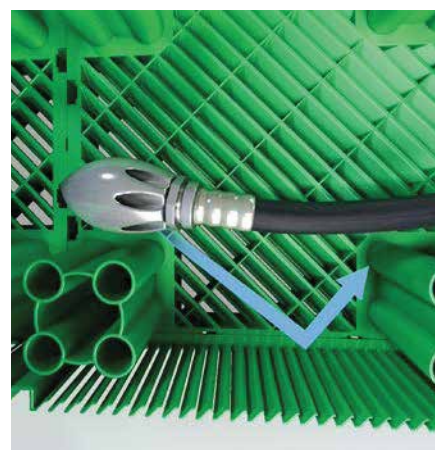
Inovativni oblik bočnih i podnih ploča, koje svojim oblikovanjem smanjuju pritisak vode kod tlačnog ispiranja te na taj način štite geotekstil od oštećenja
