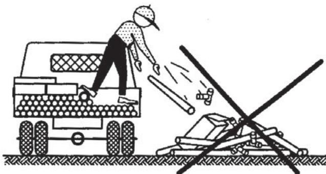
Pri temperaturama ispod točke smrzavanja potrebna je povećana pažnja pri rukovanju s PVC kanalizacionim cijevima.
