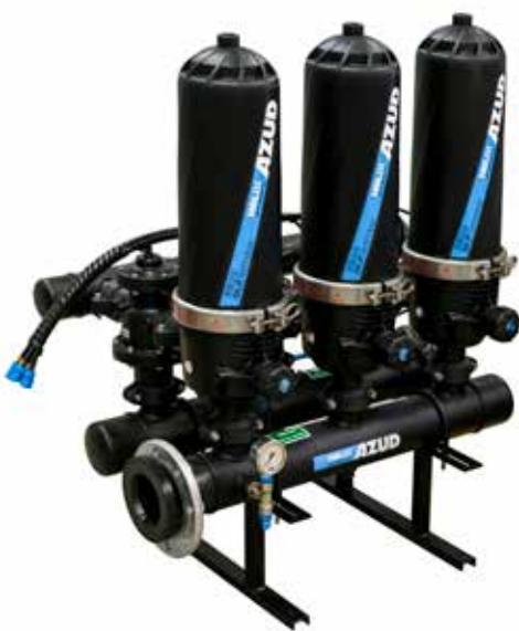
Sve filtere je potrebno redovno provjeravati i čistiti. Filterske baterije s više disk filtera mogu vam uštedeti vrijeme jer se čišćenje vrši bez prekidanja procesa navodnjavanja. Filterske baterije s više filtera se obično primjenjuju u većim sustavima za navodnjavanje s većim protokom. Ako kvaliteta vode zahtjeva, mogu se koristiti u kombinaciji s hidrociklonom ili pješčanim filterom.
